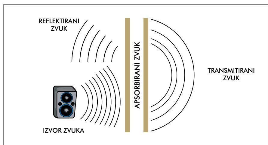
Treba imati na umu da se sustavi zvučne zaštite razlikuju u ovisnosti da li je njihova primarna funkcija zaštita od tzv. zračnog zvuka (npr. govor ili glazba) ili od tzv. udarnog zvuka (zvuka udara) koji nastaje udarom i prenosi se kroz čvrstu sredinu.
