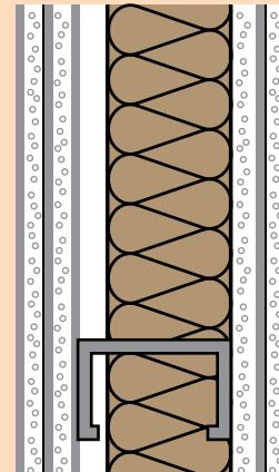
Prikazana konstrukcija pregradnog zida postiže mjeru zvučne izolacije od R<sub>w</sub> = 55 dB (mjerenje u ispitnom stanju, izvor: Knauf Gips)
