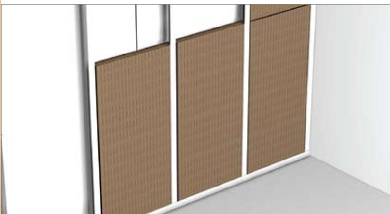
Pregradni zid zatvaramo i s druge strane gipskartonskim pločama. Još kvalitetniju zaštitu od zračnog zvuka postižemo postavom jednog ili dva dodatna sloja završne obloge od gipskartonskih ploča sa svake strane zida.
