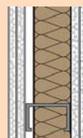
Pokusima je dokazano da prikazana konstrukcija pregradnog zida postiže protupožaru klasu F 90 (izvor: Knauf Gips).
